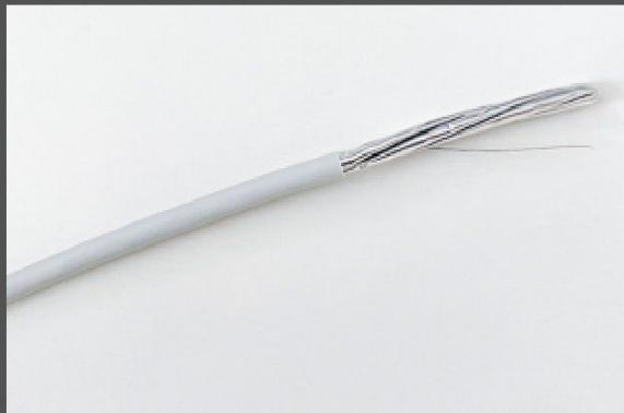
Odstraňte plášť kabelu minimálně v délce **50 mm**. V případě stíněných kabelů o něco více - tj. zemnící drátek musí být **dostatečně dlouhý** (viz dále). Při instalaci kabelů si proto nechejte na obou koncích kabelu **větší rezervy**.
